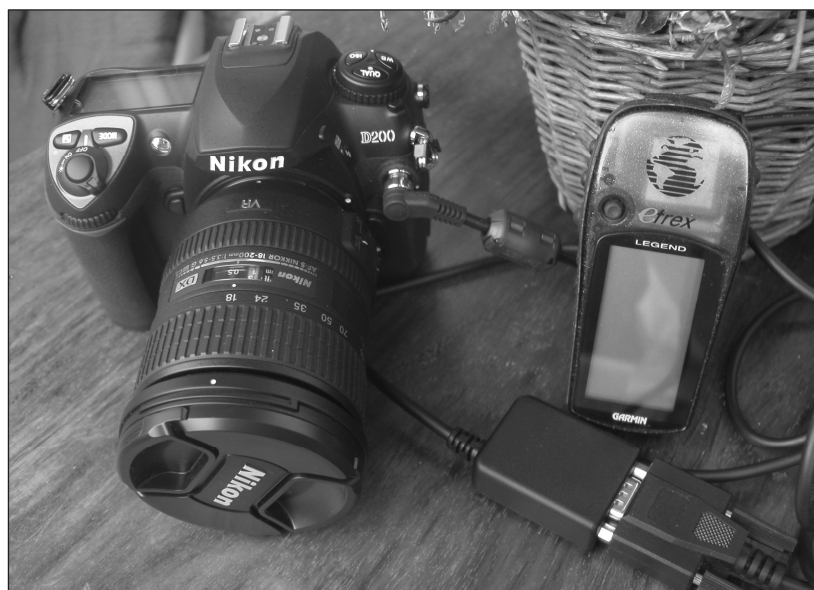
Obr. 2. Nejmodernější způsob pořizování fotografií v oblasti leteckého průzkumu nabízí spojení digitálního fotoaparátu a navigačního přístroje (stanice GPS) prostřednictvím speciálního propojovacího kabelu. Fig. 2. A set of camera and interconnected GPS station used currently to photographic and topographic data collection.
